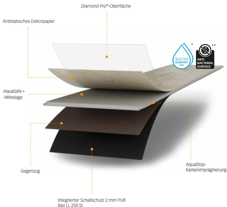
\* Kann in Feuchträumen wie z. B. Badezimmern verlegt werden. Von der Anwendung ausgeschlossen sind Außenbereiche und Nassräume wie z. B. Saunen, Duschkabinen, Dampfbäder sowie Räume mit Bodenablauf.
