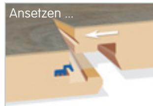
Neue Diele einfach an der Längsnut der bereits liegenden Vorderreihe ansetzen und durch Absenken mit der Dielenreihe verbinden.
