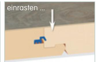
Ein kurzer Druck mit dem Daumen auf die Querfase der Kopfseite, und mit einem hörbaren Klack rastet die neue Diele ein.
