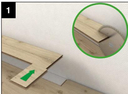
Die kopfseitige Kunststofffeder wird mit Hilfe eines Dielenreststückes nach vorne aus der Kopfnut herausgeschoben.
