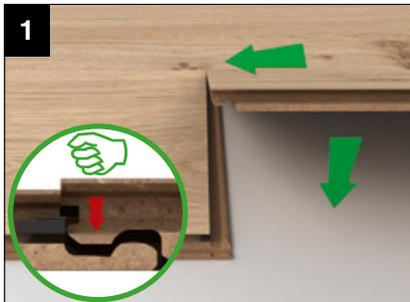
Der Boden wird kopfseitig **dicht** an der nebenliegenden Diele abgesenkt.
