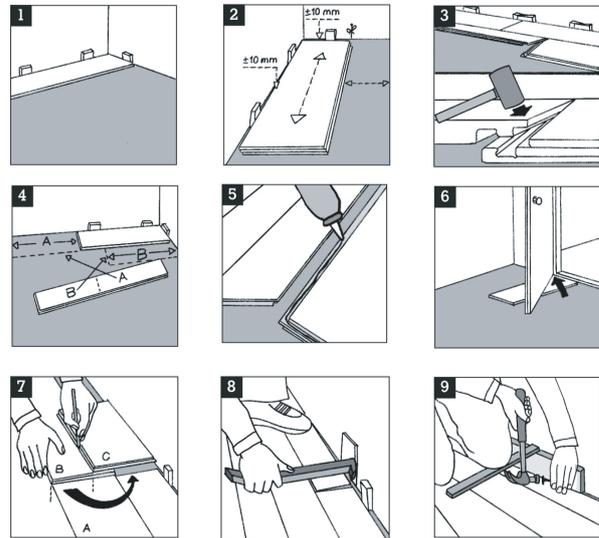
Verwenden Sie eine ausreichende Anzahl von Keilen, um den Abstand zu halten. Die Platten sollten vorzugsweise in Richtung des Lichteinfalls verlegt werden. In kleinen, schmalen Räumen (z. B. Fluren) empfehlen wir eine Verlegung entlang der Raumlänge.
