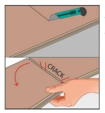
Die Kürzung der jeweiligen Paneele auf Maß können Sie mit Hilfe eines Winkels und einem Teppichmesser vornehmen. Anschließend können Sie das Paneel über "die Kante brechen".
