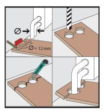
Wo beispielsweise Heizungsrohre aus dem Boden ragen, bitte zuerst das Paneel auf die richtige Länge zuschneiden, dann das Paneelstück neben den eigentlichen Platz legen und die Aussparungen mit dem Zollstock abmessen und anzeichnen. Auch hier bitte immer an den mind. 7 mm umlaufenden Abstand der Dehnungsfuge denken. Nun können Sie die markierten Stellen ausbohren. Anschließend sägen Sie das Paneel zu. Anschließend hinter dem Heizungsrohr platzieren und mit dem Paneel wieder dicht zusammenfügen.
