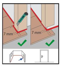
Türzargen aus Holz können gekürzt werden. Legen Sie dazu ein Paneel mit der Dekorseite nach unten gegen die Zarge. Kürzen Sie nun mit einer geeigneten Säge entlang des Paneels die Türzarge. Danach lässt sich die Paneele einfach mit der Dekorseite nach oben unter die Zarge schieben. Bei Türzargen, die nicht gekürzt werden können, schneiden Sie das Paneel entsprechend zu und beachten Sie die den mind. 7 mm umlaufenden Abstand der Dehnungsfugen.
