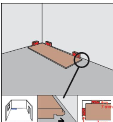
Verlegen Sie die erste Reihe so, dass die Feder der Kopf- und Längsseite zur Wand zeigen. Fixieren Sie die erste Reihe mit Abstandskeilen (mind. 7 mm) zur Wand.
