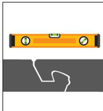
Im Anschluss wird mittels eines Acrylhammers vorsichtig nachgeklopft. Dies erleichtert die Verlegung und sorgt dafür, dass die stirnseitige Verbindung vollständig und passgenau verriegelt wird. Achten Sie darauf, dass die Paneele absolut bündig zueinander liegen.
