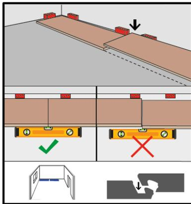
Klicken Sie das zweite Paneel stirnseitig in das jeweils vorherige Paneel. Dies erfolgt von oben durch leichtes Eindrücken per Hand bis die Click-Verbindung einrastet.
