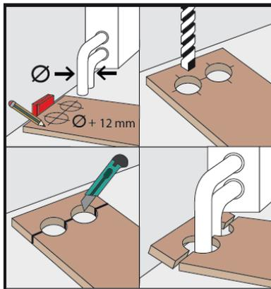
Wo beispielsweise Heizungsrohre aus dem Boden ragen, bitte zuerst das Paneel auf die richtige Länge zuschneiden, dann das Paneelstück neben den eigentlichen Platz legen und die Aussparungen mit dem Zollstock abmessen und anzeichnen. Auch hier bitte immer an den mind. 7 mm umlaufenden Abstand der Dehnungsfuge denken. Nun können Sie die markierten Stellen ausbohren. Anschließend sägen Sie das Paneel zu. Anschließend hinter dem Heizungsrohr platzieren und mit dem Paneel wieder dicht zusammenfügen.
