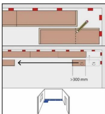
Die nächste Reihe beginnen Sie mit dem Reststück der vorherigen Reihe. Reststücke sollten aber mindestens eine Länge von 30 cm aufweisen, um einen optimalen Halt zu gewährleisten.
