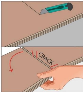
Die Kürzung der jeweiligen Paneele auf Maß können Sie mit Hilfe eines Winkels und einem Teppichmesser vornehmen. Alternativ können Sie auch einen Laminatcutter oder eine Stichsäge verwenden. Anschließend können Sie das Paneel über „die Kante brechen“.
