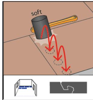
Das erste Paneel der zweiten Reihe wird durch längsseitiges Einwinkeln in die erste Reihe fixiert. Hierzu die längsseitige Feder schräg von oben in die längsseitige Nut des ersten Paneels der ersten Reihe ansetzen. Dann das Paneel absenken, bis diese flach aufliegt.
