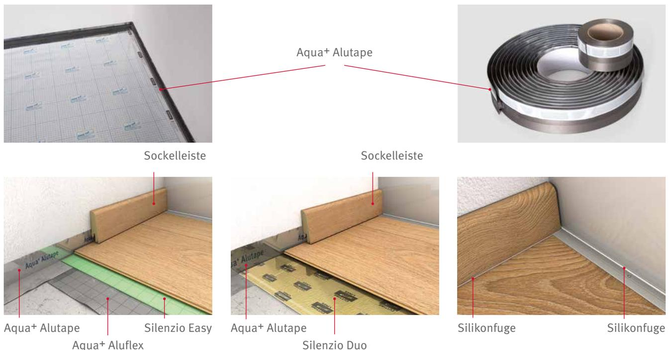
**Achtung!** Es ist unbedingt erforderlich, die systembezogenen Feuchteschutzfolie vollflächig zu verlegen und mit dem EGGER Aqua+ Alutape im Wandanschlußbereich wannenförmig abzudichten (Bild 1 + 2).
