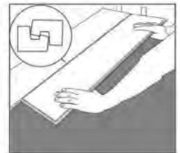
4. Setzen Sie die zweite Diele so an, dass keine Fuge zwischen den Kurzenden der Dielen zu sehen ist und die Diele über die Gesamtlänge der Verbundleiste in der vorausgehenden Reihe anliegt. Achten Sie darauf, dass die Federseite auf der Längseite der Diele mit der Nutseite der vorausgehenden Reihe übereinstimmt. Drücken Sie dann die Diele mithilfe eines Handrollers oder Gummihammers nach unten.
