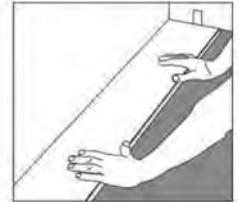
2. Führen Sie die nächste Diele an das Kurzende der ersten und achten Sie darauf, dass die Eckpunkte übereinstimmen. Drücken Sie dann die Diele mithilfe eines Handrollers oder Gummihammers nach unten. Stellen Sie sicher, dass die Längsseiten der Dielen geradlinig ausgerichtet sind. Führen Sie die Verlegung der ersten Reihe wie beschrieben aus. Schneiden Sie die letzte Diele der ersten Reihe auf die richtige Länge zurecht.
